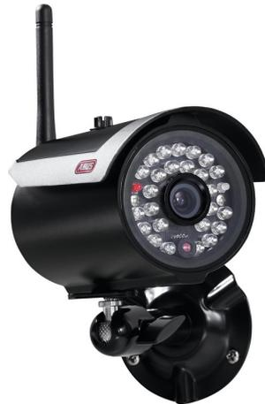
Cette caméra sans fil d'extérieur à infrarouge de 2,4 GHz est un accessoire en option du moniteur TFT 7" sans fil. Vous avez la possibilité d'utiliser jusqu'à 4 caméras de ce type avec le moniteur.
