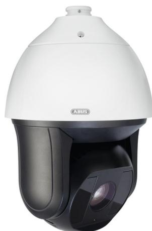
Le dôme PTZ IP fournit des flux vidéo d'une résolution de 4MPx pour jusqu'à 25fps. Le boîtier IP66 résistant aux intempéries permet une utilisation en extérieur, et ce de jour comme de nuit grâce aux LED IR intégrées. Il est à tout moment possible d'accéder facilement à la caméra via l'application Link Station.
