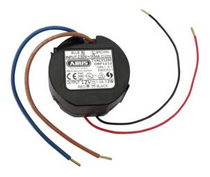
Das stabilisierte Mini-Einbaunetzteil (230 V AC / 12 V DC, 1 A) dient der Spannungsversorgung Ihrer Videokomponenten. Mit seinen kompakten Maßen eignet es sich besonders gut als Unterputznetzteil zum Einbau in eine 55 mm Unterputzdosen und überall dort, wo wenig Platz für die Stromversorgung vorhanden ist.
