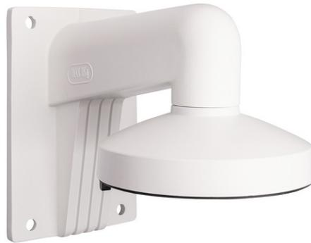
Der Wandhalter ist ein optionales Zubehör für den IP Mini Dome IPCB54511A, IPCB54511B, IPCB58511A, IPCB58511B. Er dient der professionellen Wandmontage der Dome Kamera in waagerechter Position. Die robuste Konstruktion aus Aluminium ermöglicht eine geschützte, innenliegende Kabelführung und eignet sich sowohl für den Innen- wie auch Außenbereich.
