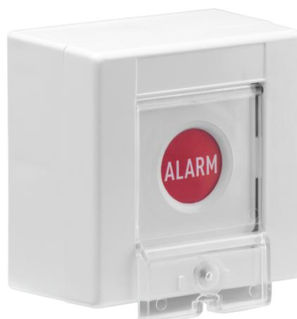
Le bouton de panique vous garantit à 100 % le déclenchement d'une alarme lorsque vous avez besoin d'aide. Vous pouvez installer le bouton de panique comme dispositif isolé ou l'intégrer dans votre installation d'alarme. Il est doté d'une surveillance anti-sabotage. Un contact NO ou NC est accessible pour déclencher l'alarme anti-intrusion et l'alarme anti-sabotage. Le bouton de panique est certifié VSÖ et VdS C.
