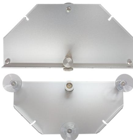
Gabarit de collage pour le collage des détecteurs de bris de verre. Le gabarit de collage est conçu de manière à ce que la distance entre le capteur et le cadre soit automatiquement donnée. En outre, le gabarit de collage garantit une pression constante sur les capteurs pendant le processus de durcissement de la colle.
